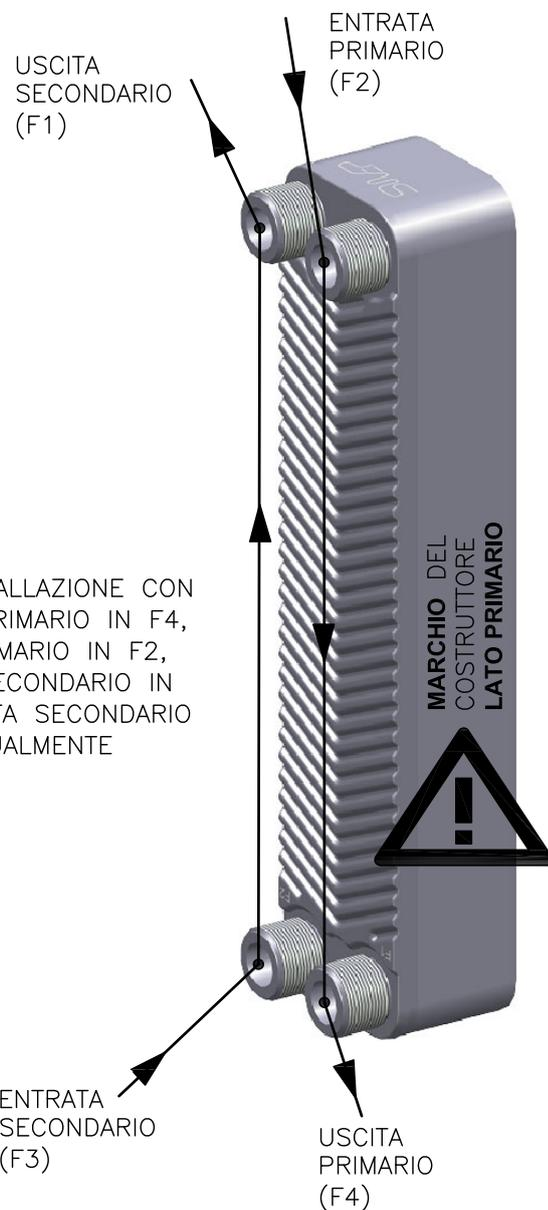
NOTA: L'INSTALLAZIONE CON L'ENTRATA PRIMARIO IN F4, L'USCITA PRIMARIO IN F2, L'ENTRATA SECONDARIO IN F1 E L'USCITA SECONDARIO IN F3, E' UGUALMENTE AMMESSA.
