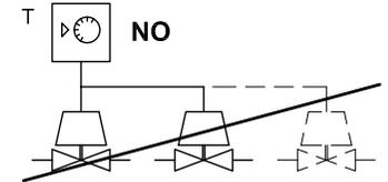
Più servomotori con comando a 3 fili **NON possono essere collegati in parallelo** ad un unico termostato / controllo.
