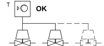
Più servomotori con comando a 2 fili **possono essere collegati in parallelo** ad un unico termostato / controllo.
